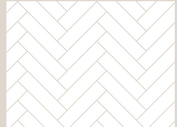
4 posa a lisca di pesce Herringbone installation
